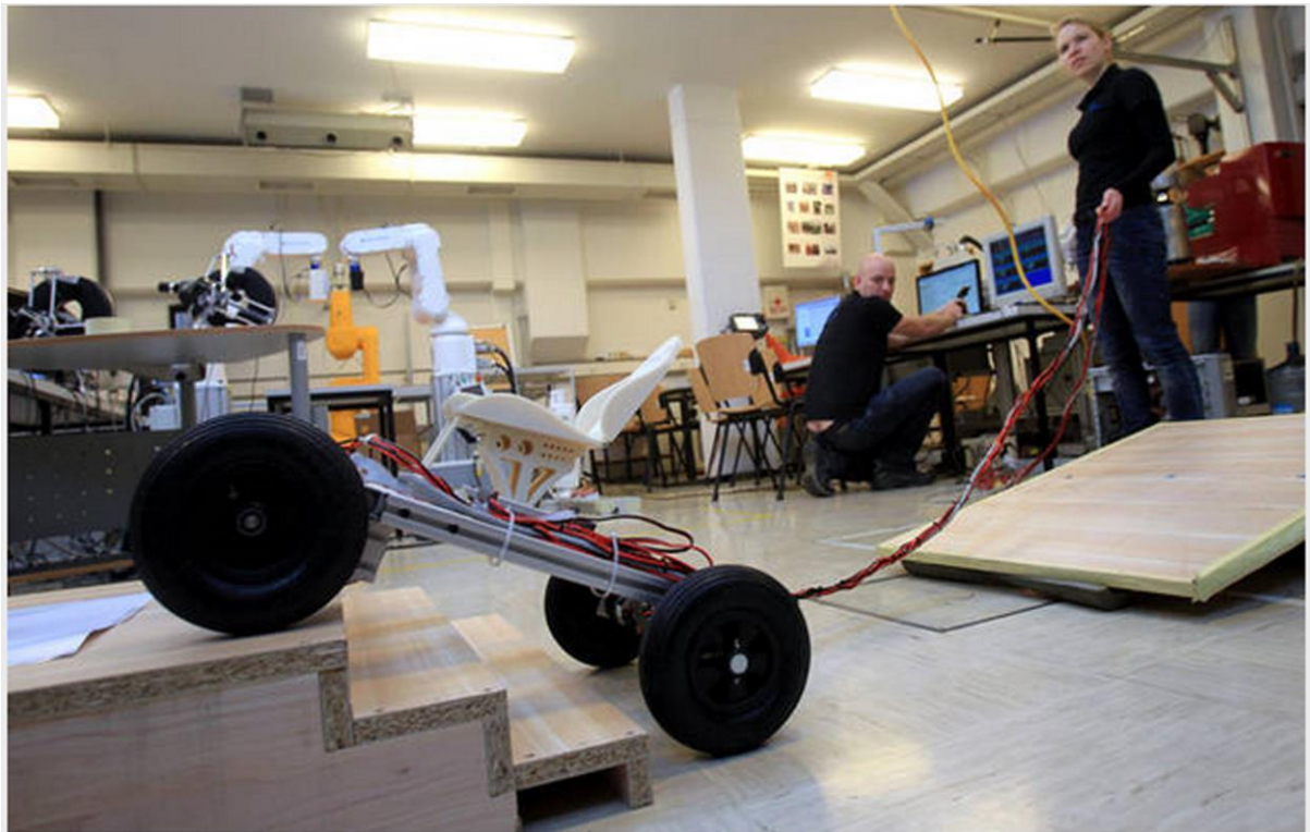
Na modelčku preizkušajo krmiljenje pogonskih sklopov. Foto: Igor Zaplatil
