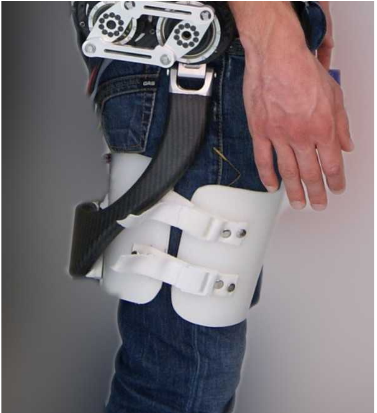
Pripomoček zaznava naravno gibanje in ga skuša posnemati. (Foto: Fakulteta za elektrotehniko UL )
